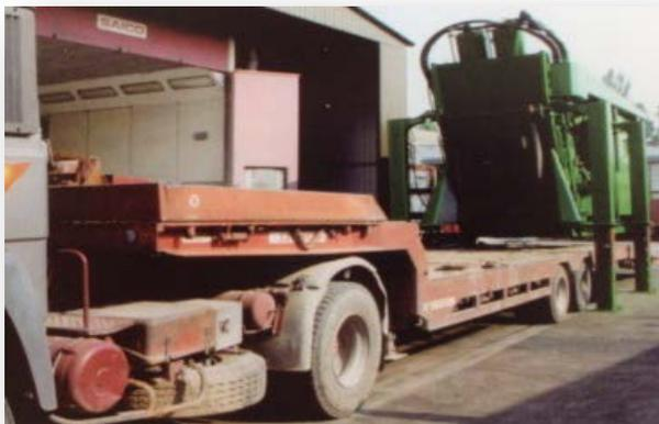
Un double vérin tandem de 2000 tonnes permet de couper simultanément jusqu'à 2 HEA de 800mm, par exemple.
