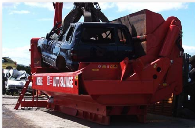
Chargement des VHU au grappin intégré
