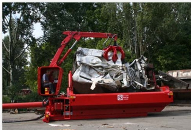
Chargement, mise en balle, déchargement en ~ 4 min
